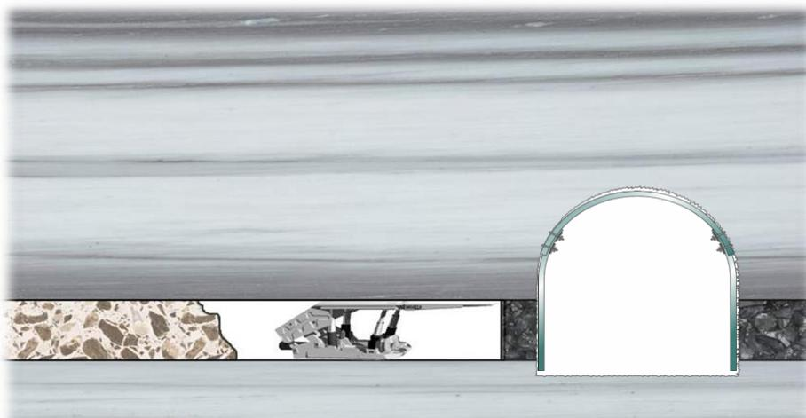
Рис. 5.1. Плоское сечение выработки, сопряженной с выработанным пространством лавы
